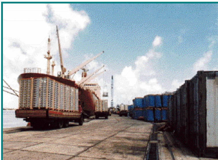
Figura 3.2: Porto de Natal – Embarque de frutas paletizadas com a utilização de caminhões no transporte interno em “embarque direto” (Foto: CODERN)
