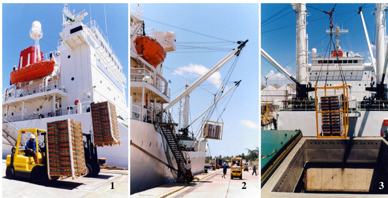
Figura 3.1: Porto de Natal: Seqüência de Embarque dos Paletes de Frutas – 1 - Movimentação dos paletes com empilhadeiras ao costado do navio; 2 - Içamento dos paletes com equipamentos de bordo; 3 – Colocação do palete no porão do navio reefer (Fotos: CODERN)
