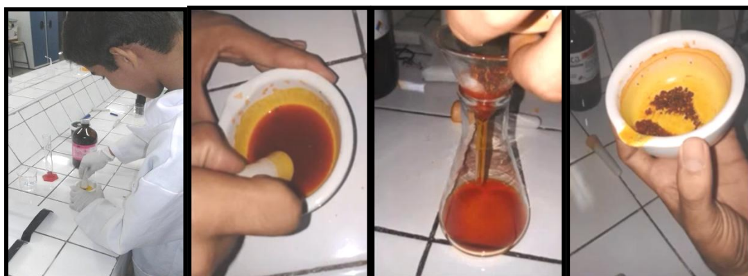
Figura 3 – Preparação do extrato etanólico: (a) maceração das sementes de urucum, (b) adição de etanol as sementes, (c) filtração do extrato e (d) sementes após a extração.
