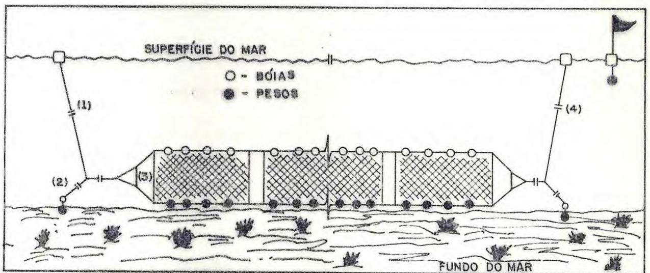
Figura 2- Modelo esquemático da rede-de-espera (caçoeira), utilizada nas pescarias de lagostas: (1)- arengue (bóia de isopor e cabo de sisal); (2)- amarra (peso e cabo de sisal); (3)- galho (vara com 2,5 cm de diâmetro e 1,5 metros de comprimento); (4)- bulandeira (sistema bóia e bandeira, cabo de sisal e peso).
