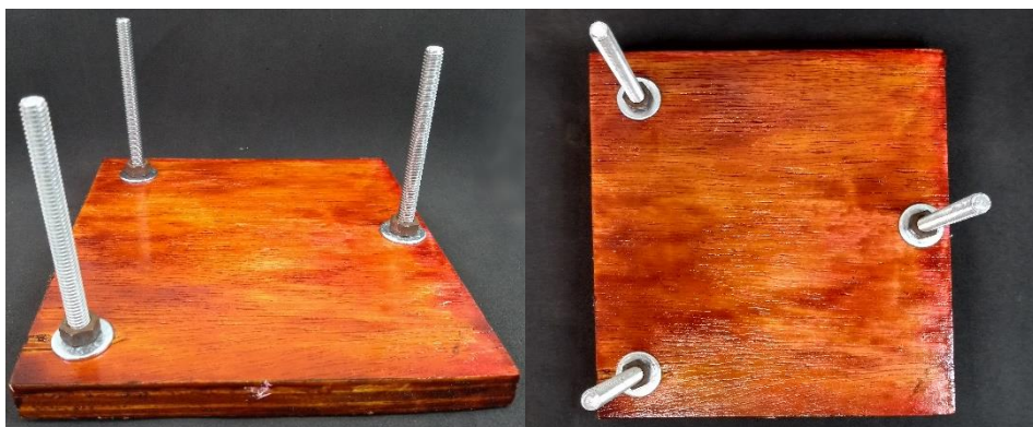
Figura 2 - Visão lateral e superior das placas de madeira com os parafusos já fixados.
