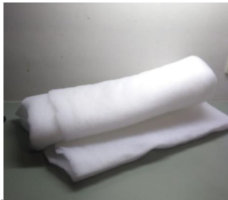
Figura 2 – Manta acrílica aplicada ao sistema de filtragem mecânica.
