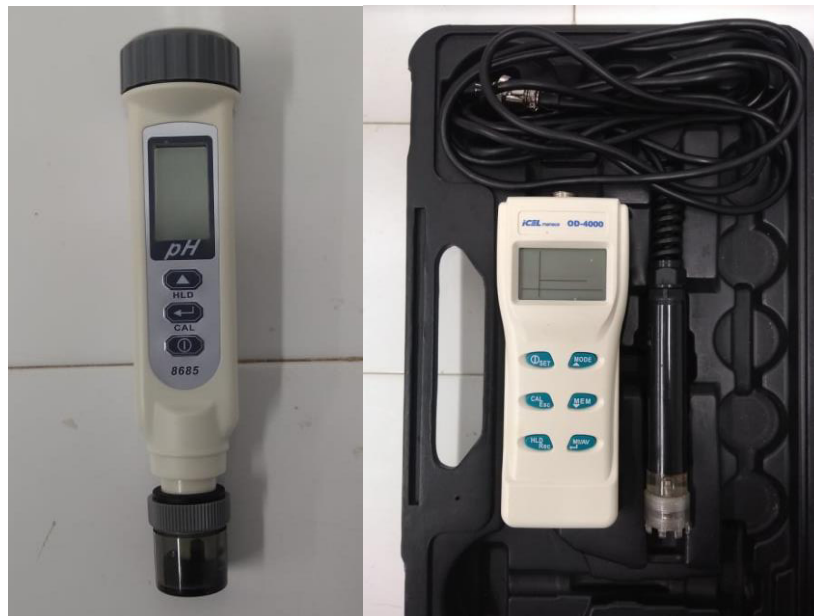
Figura 9 – Sondas eletrônicas para avaliação de oxigênio dissolvido, pH e temperatura.
