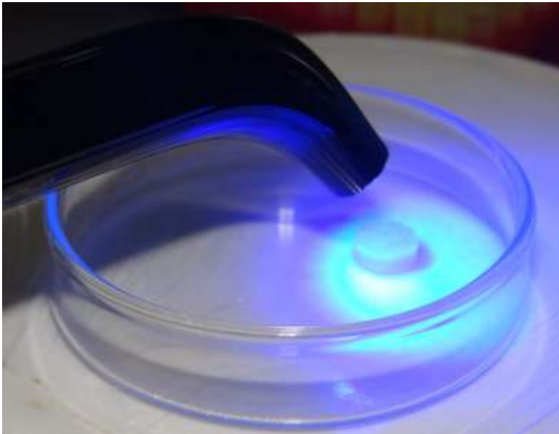
FIGURA 9. Exemplo da Terapia Fotodinâmica (LED) aplicada no espécime de resina acrílica.
