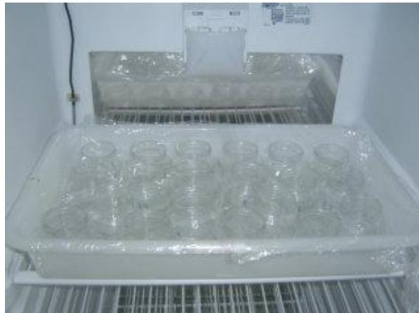
Figura 15 - Teste de toxicidade crônica com *Daphnia magna*. LABOSAN – UFC, 2010.
