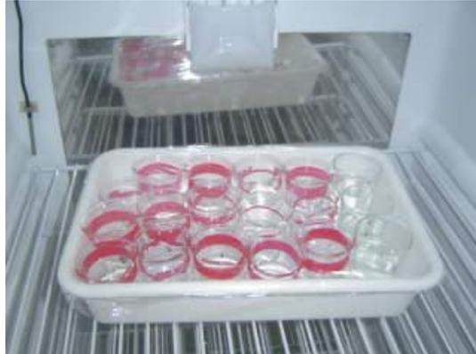
Figura 13 - Teste de toxicidade aguda com *Daphnia magna*. LABOSAN - UFC, 2010.
