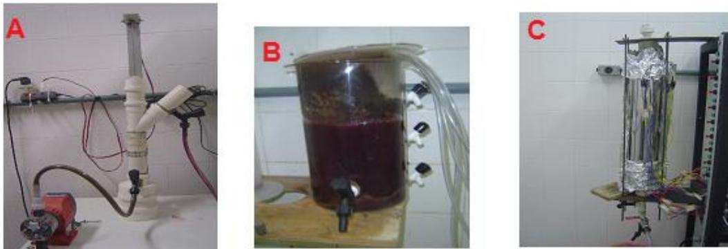
Figura 21 – Foto dos reatores utilizados no tratamento do esgoto têxtil sintético.
