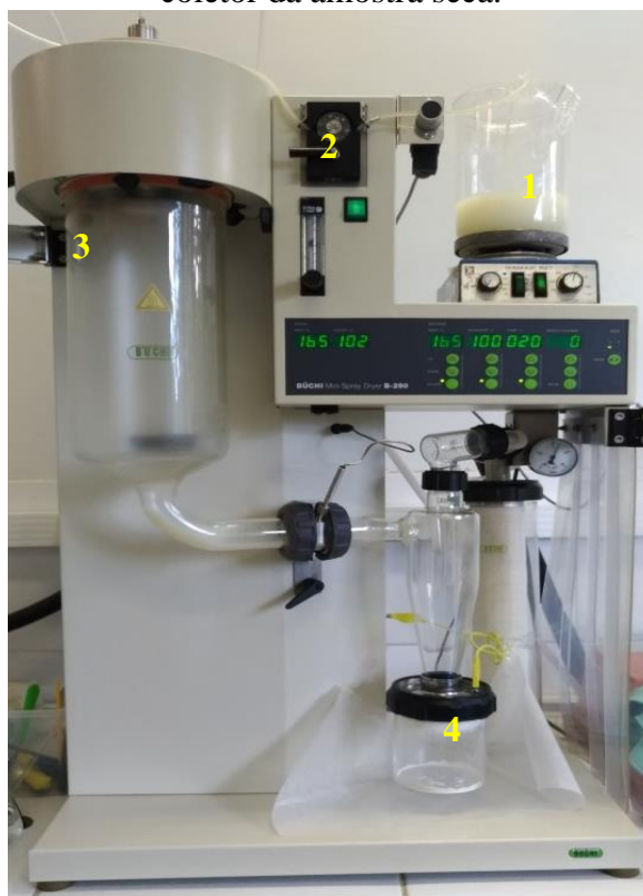
Figura 10 - Spray dryer : 1) Amostra líquida; 2) Bomba; 3) Câmara de secagem; 4) Cilindro coletor da amostra seca.
