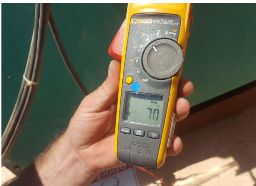
Figura 35 - Valor de corrente estabelecido no ensaio.
