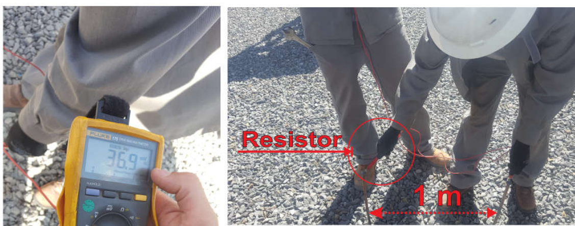
Figura 37 - Medições dos potenciais de passo. A esquerda valor mensurado, a direita procedimento de medição.
