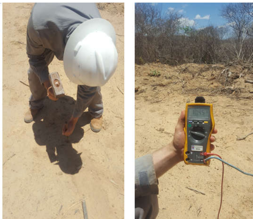
Figura 36 - Medição da resistividade do solo. Do lado esquerdo haste fincada no solo. Do lado direito o valor mensurado de tensão.
