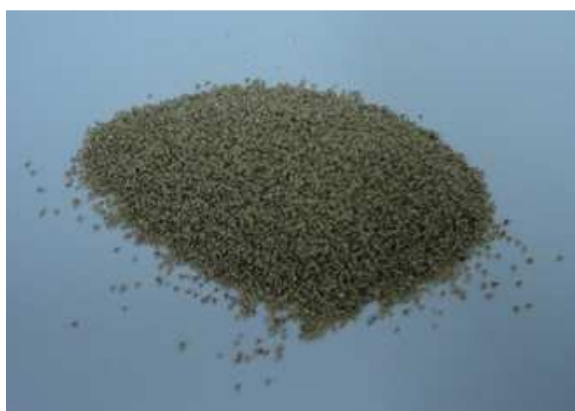
Figura 3.1 – Rocha arenítica desagregada.
