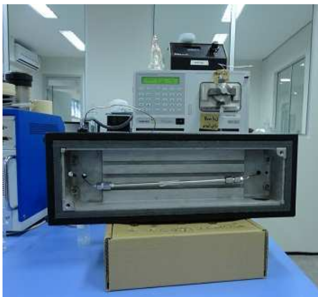
Figura 3.4 – Sistema de adsorção em leito fixo utilizado para realização dos ensaios.
