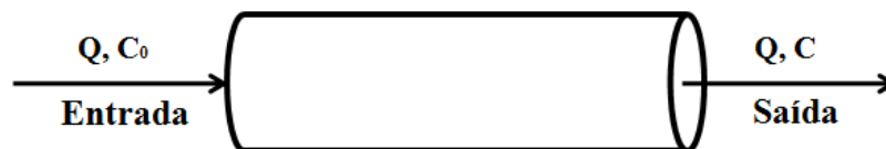
Figura 3.6 – Esquema de uma operação em leito fixo.
