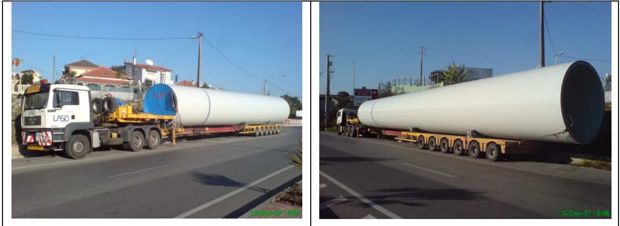
Figura 6 – Transporte de um segmento tubular de uma torre eólica (VILARFORMOSO, 2010)
