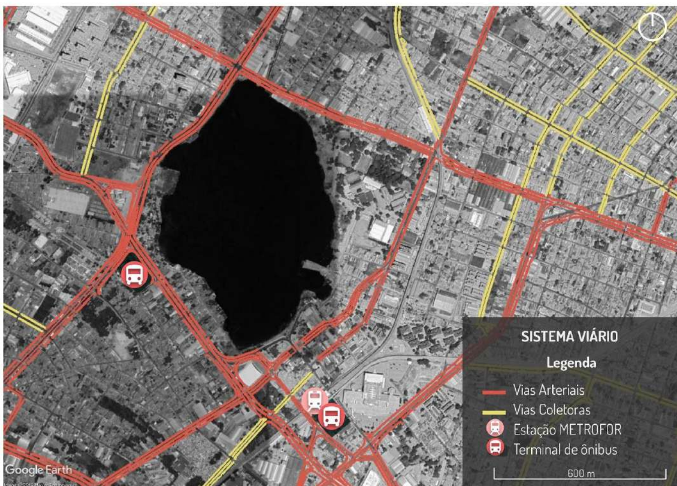
Imagem 84: Mapa do Sistema Viário da região, mostrando vias de fluxo intenso e moderado que passam pela Parangaba. Fonte: Elaborado pela autora usando como base o Google Earth.
