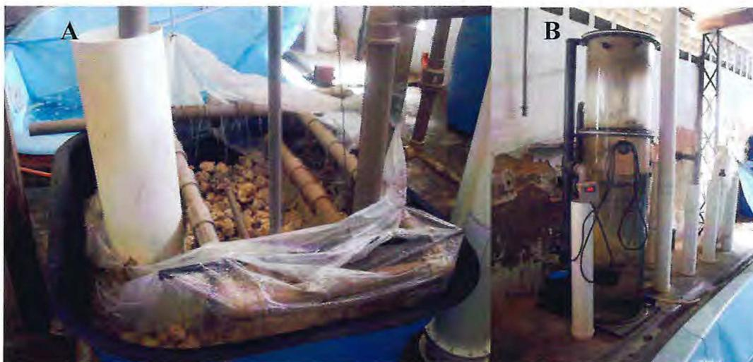
Figura 6 – Sistemas de filtragem adotado nas empresas exportadoras (a) Filtro Biológico com "rocha viva" para fixação de bactérias nitrificantes; (b) Visão geral do fracionador de proteínas ("skimmer") utilizado no sistema de recirculação para manutenção de peixes ornamentais.
