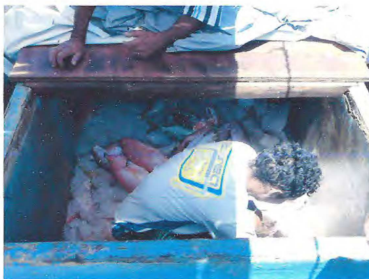
Figura 11 – Câmara geleira existente nas embarcações: local de armazenamento do gelo e pescado.
