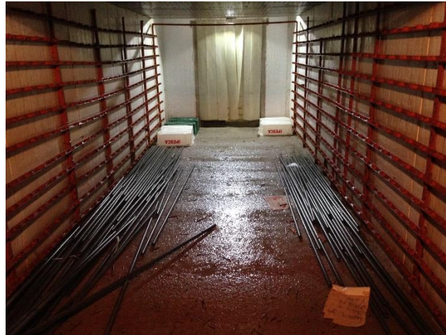
Figura 11 – Túnel de congelamento descarregado para limpeza com detalhes da porta de entrada a porta de saída do produto.
