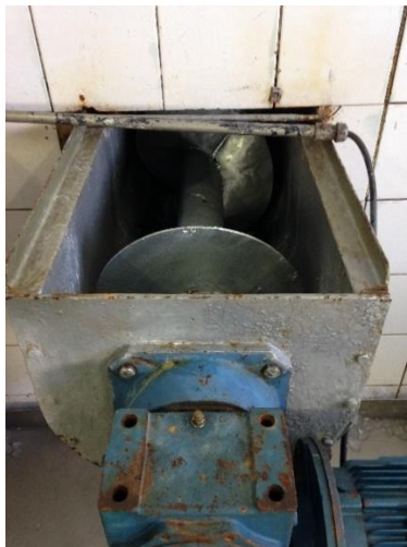
Figura 23 – Sistema de parafuso helicoidal de distribuição do gelo em escama.
