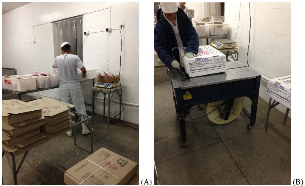
Figura 13 – Pesagem e classificação das lagostas (A) e máquina de arquear caixas (B).
