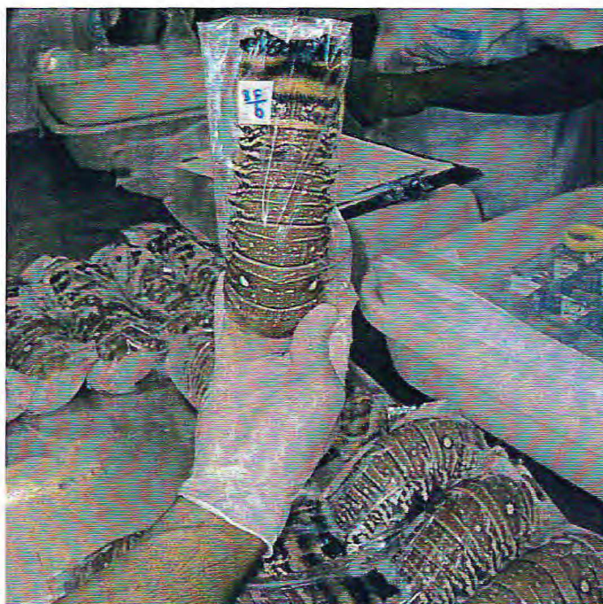
FIGURA 12 Cauda de lagosta envolvida em filme plástico de polietileno de baixa densidade, etiquetada com tipo e quantidade na indústria beneficiadora de pescado INTERFRIOS-Intercâmbio de Frios S/A, em Fortaleza/Ceará.
