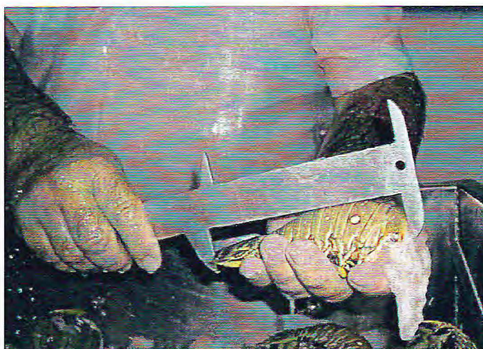
FIGURA 8 Paquímetro de medição da cauda de lagosta na indústria beneficiadora de pescado INTERFRIOS-Intercâmbio de Frios S/A, em Fortaleza/Ceará.
