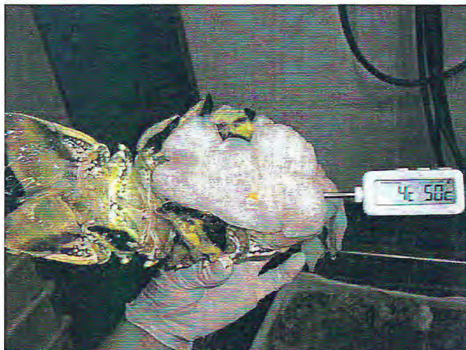
FIGURA 10 Termômetro indicando a temperatura no interior da lagosta na indústria beneficiadora de pescado INTERFRIOS-Intercâmbio de Frios S/A, em Fortaleza/Ceará.
