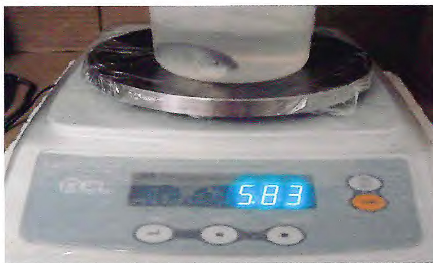
Figura 8: Realização de biometria, medidas de peso em balança eletrônica com precisão de 0,01g.
