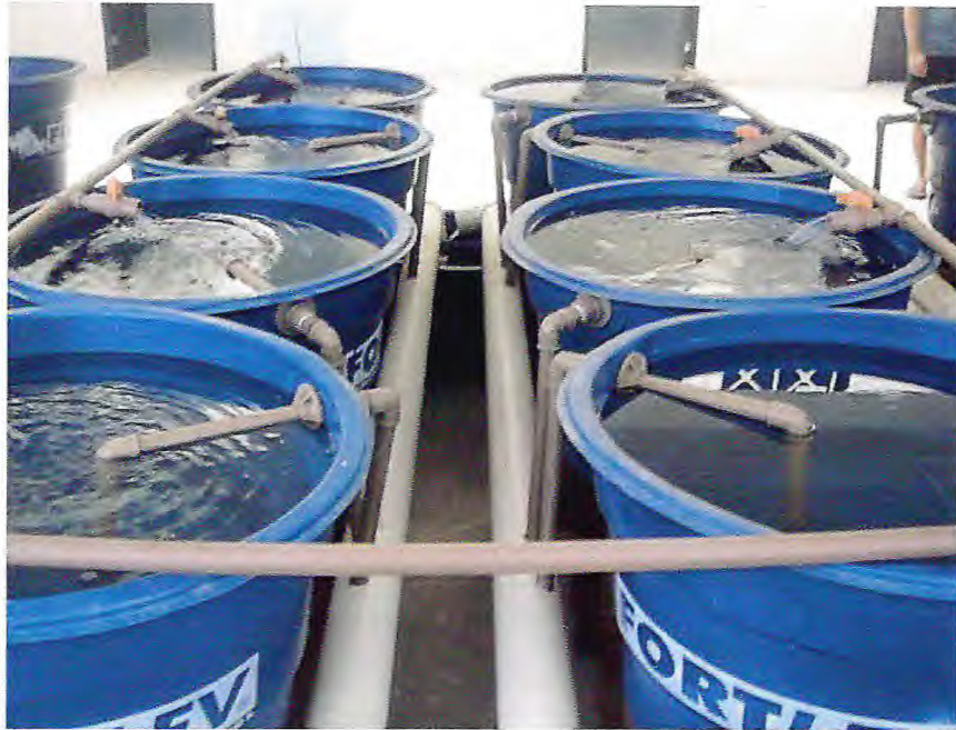
Figura 10: Vista geral do sistema de recirculação com caixas de polietileno com capacidade de 100L.
