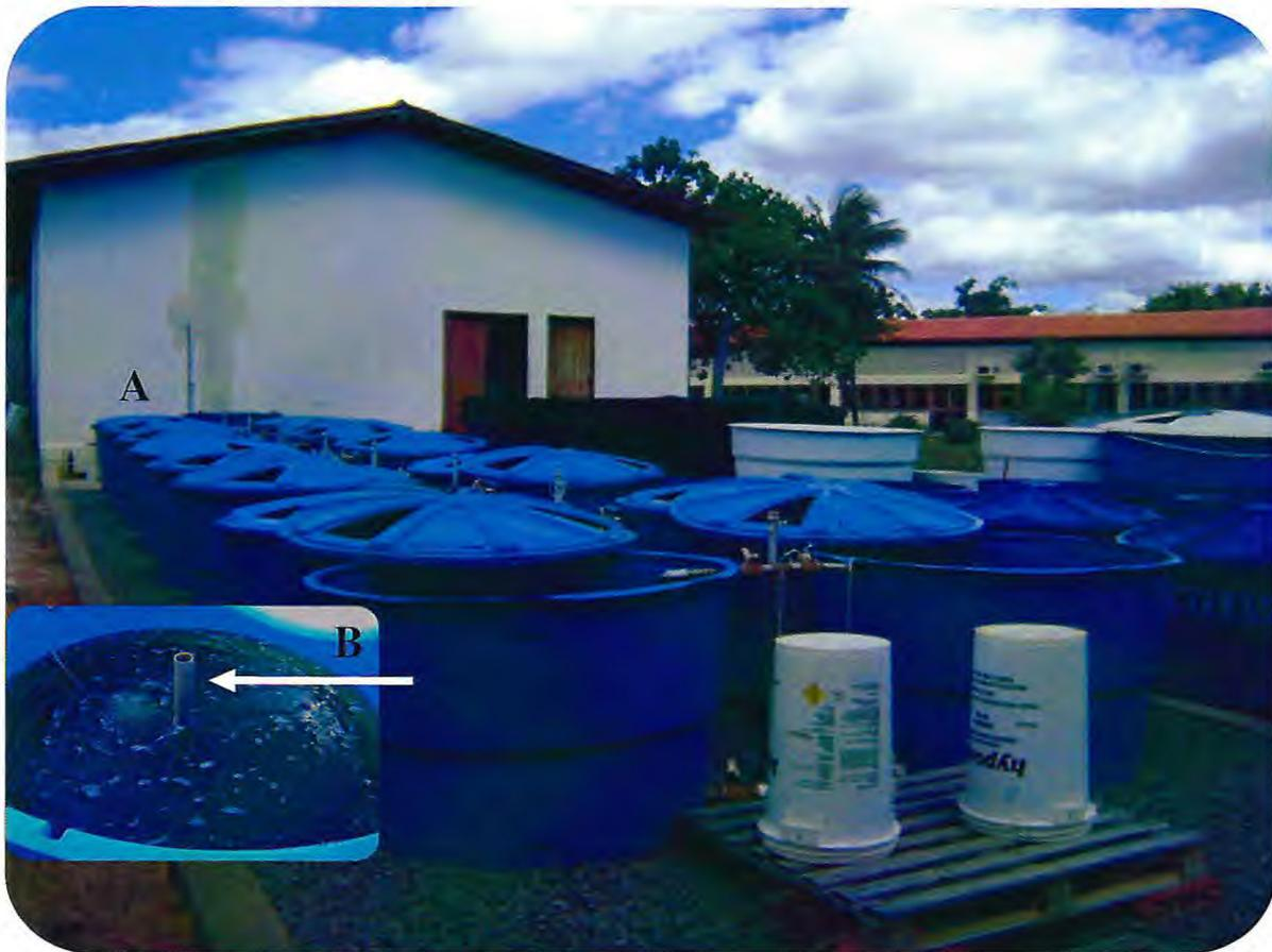
Figura 10 - Área externa do laboratório. (A) Sistema de 16 tanques, usados para produção de alimento vivo e larvicultura do ariacó. (B) No detalhe, o dreno central de escoamento da água.
