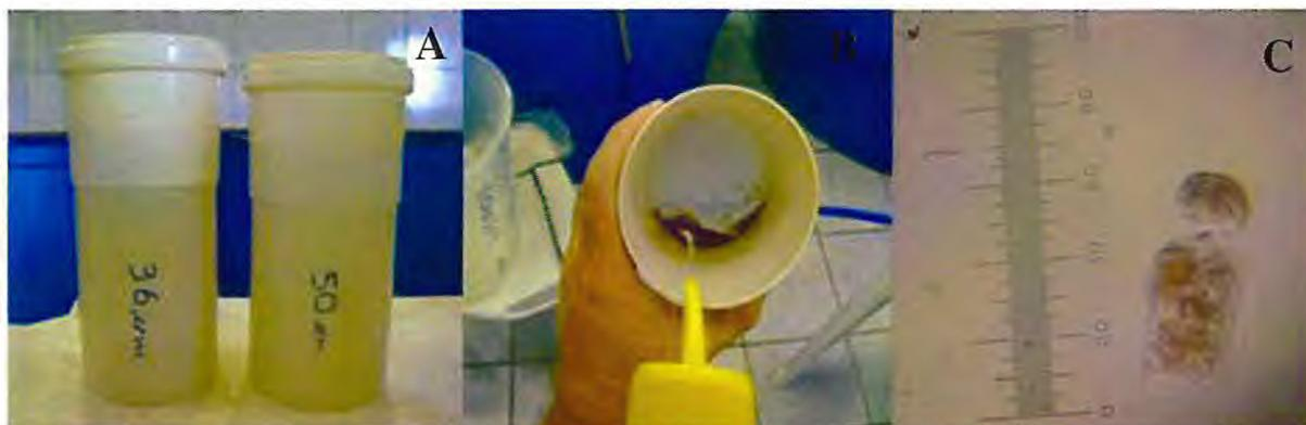
Figura 13 – Manejo dos rotíferos no laboratório (A) Telas utilizadas para a coleta, lavagem e separação dos rotíferos. (B) Método de lavagem dos rotíferos com piceta e água tratada. (C) Rotífero adulto de *Brachionus plicatilis* com ovos, observados em microscópio óptico (Objetiva 10x).
