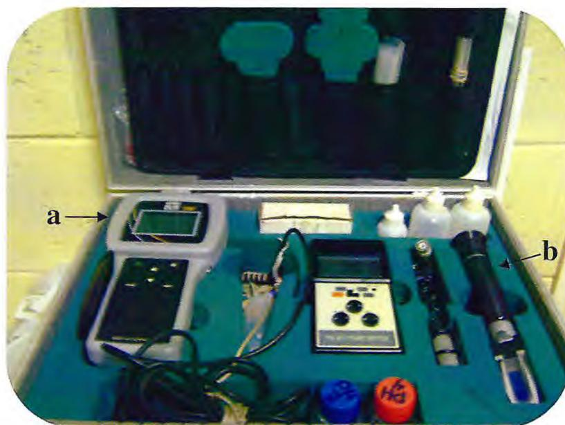
Figura 19 – Equipamentos utilizados para medir os parâmetros físico-químicos da água. (a) Oxímetro utilizado para medir a temperatura e o oxigênio dissolvido. (b) Refratômetro óptico que mede a salinidade da água em ppt.
