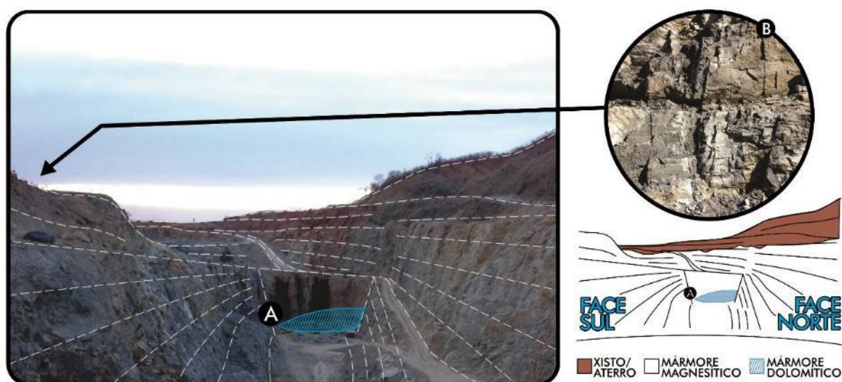
Figura 08 – Setor W da cava. A) Afloramento de Mármore maciço; B) Afloramento de mármore bandado.
