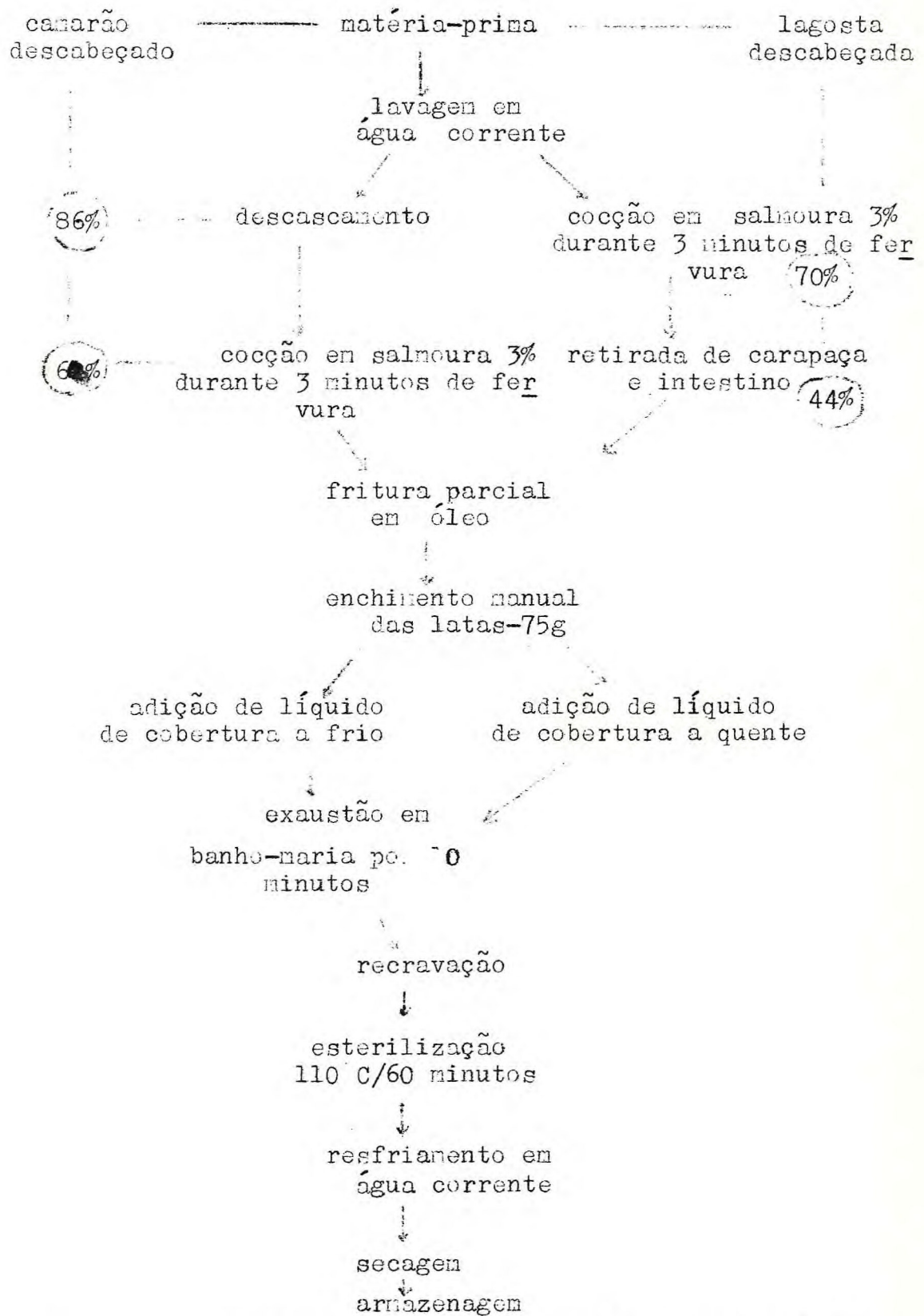
Figura 2 - fluxograma seguido na obtenção de caudas de lagosta e camarão, incluindo-se dados de rendimento.
