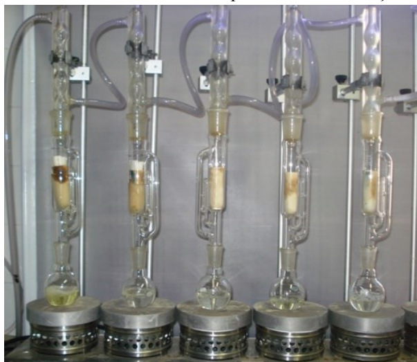
Figura 38 - Vista da Bateria de Sebelim promovendo a extração de gordura.
