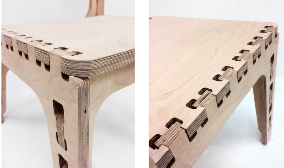
Figura 16 – Conexão realizada com corte computadorizado
