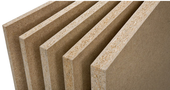
Figura 6 – Estrutura painéis de MDP
