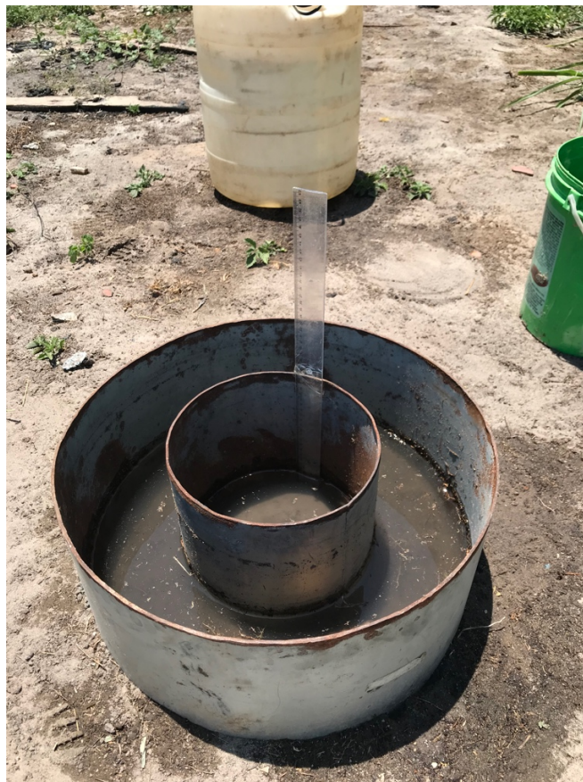
Figura 8 - Aparelhagem para ensaio de infiltração (anéis concêntricos e régua).
