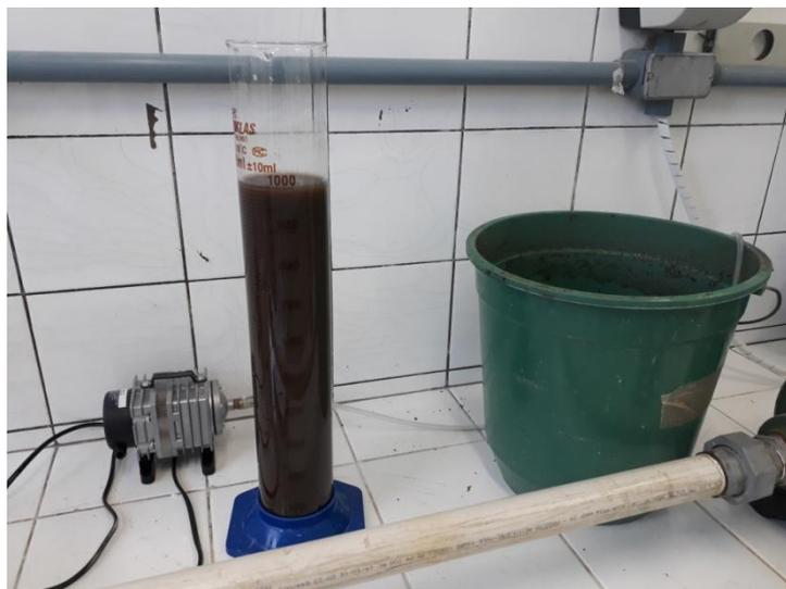
Figura 4.7. Sistema do ensaio de decaimento do lodo. Ele consiste no aerador do tipo compressor e o recipiente para conter o lodo (balde verde). A proveta era utilizada para análises de IVL. Fonte: elaborado pelo autor.
