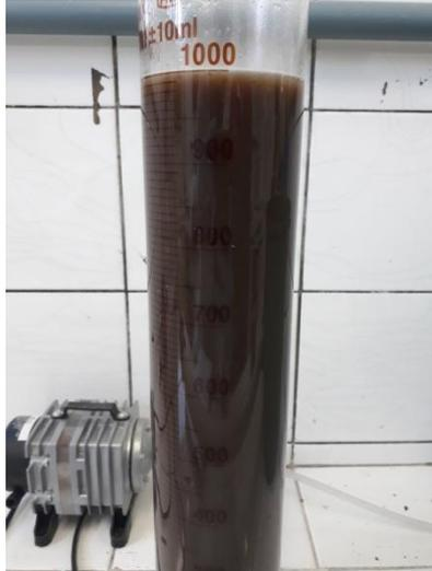
Figura 4.2. Lodo proveniente do reator carrossel de ETE em Fortaleza-CE. Fonte: elaborado pelo autor.
