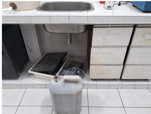
Figura 4.3. Sistema de manutenção do lodo, que está contido no recipiente de 15 L, acoplado a um compressor de ar para manutenção de condições aeróbias. Fonte: elaborado pelo autor.
