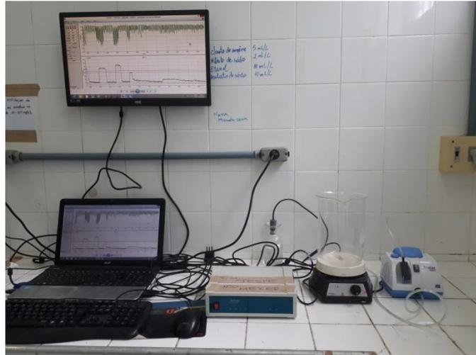
Figura 4.4. Equipamentos do sistema utilizado nos ensaios respirométricos. Computador com *software* Resp43 e monitor com o respirograma, respirômetro Beluga, agitador magnético, bquer com volume de 2 litros e aerador do tipo compressor. Fonte: elaborado pelo autor.
