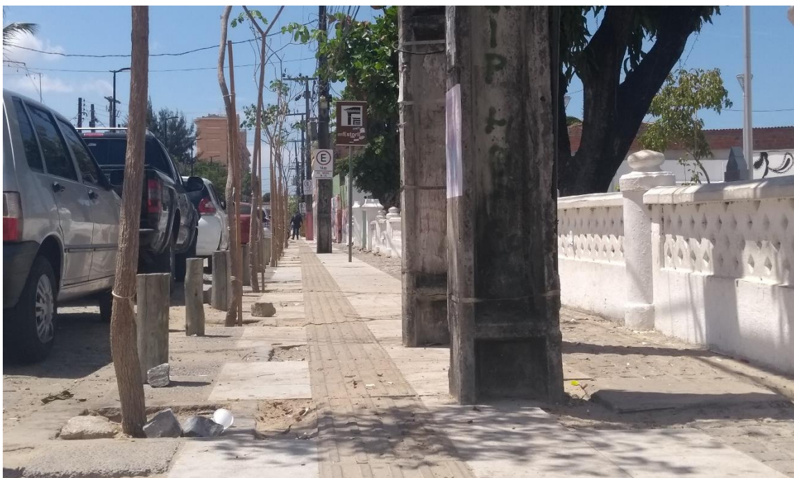
Figura 22 - Diminuição da faixa de circulação da calçada devido aos postes. Em frente ao Estoril, Fortaleza.
