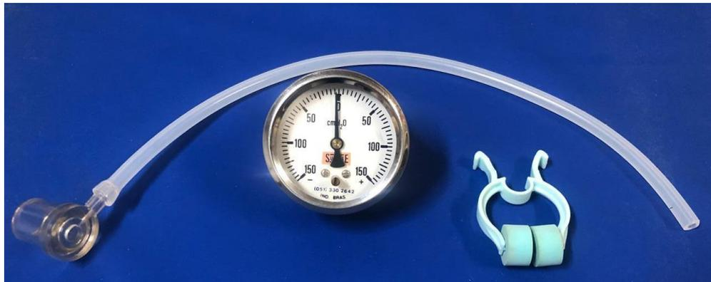
**Figura 5:** Manovacuômetro analógico para mensurações da pressão inspiratória máxima e pressão expiratória máxima.
