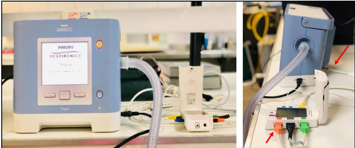
**Figura 8:** Montagem do experimento mostrando o Trilogy<sup>®</sup> conectado ao polissonógrafo Alice PDX<sup>®</sup> através de um cabo (setas vermelhas) para aquisição das curvas da ventilação mecânica de fluxo, volume e pressão x tempo.
