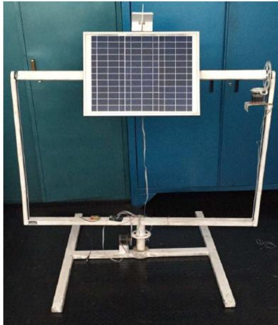
Figura 5 - Estrutura do protótipo de seguidor solar.
