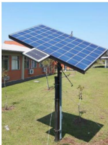
Figura 4 - Estrutura do seguidor solar no campus Farroupilha do IFRS.
