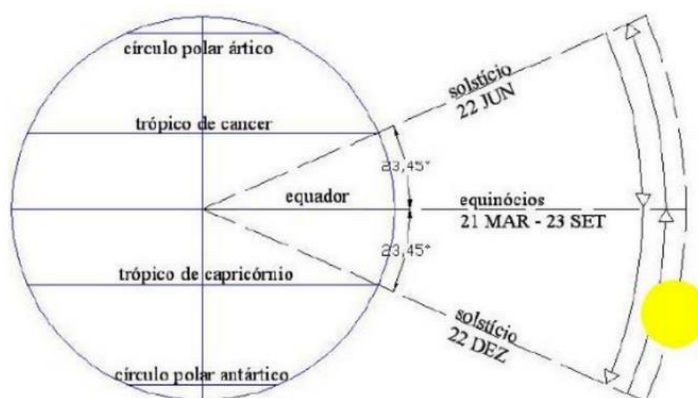
Figura 17 - Movimento anual aparente do Sol na direção norte-sul, associado à variação da sua declinação.
