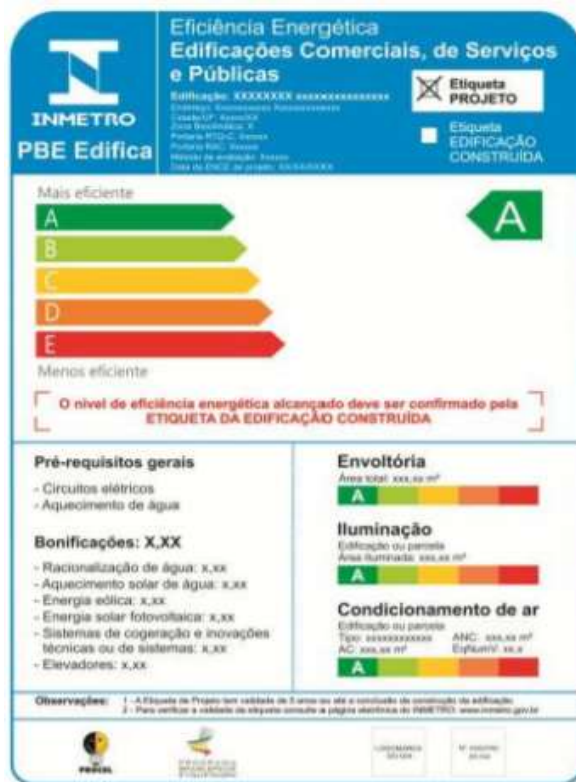
Figura 6 – Exemplo de ENCE de projeto de Edificação Comercial, de Serviço ou Pública
