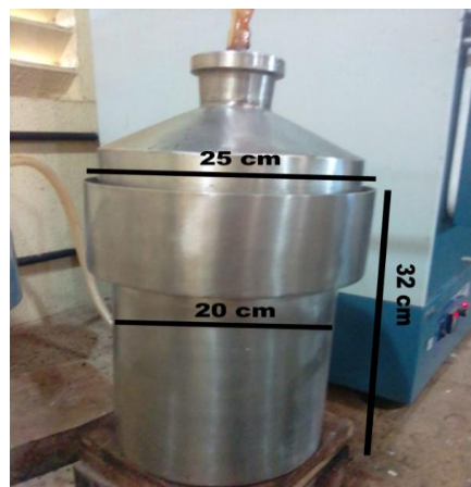
Figura 17 – Visão geral de uma dorna de aço inox com selo d'água demonstrando suas dimensões externas.
