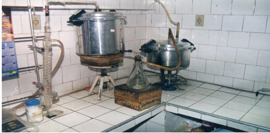
Figura 16 – Visão geral de um conjunto completo para extração de óleo essenciais por arraste a vapor utilizando panela de pressão adaptada como dorna e frasco kitazato .
