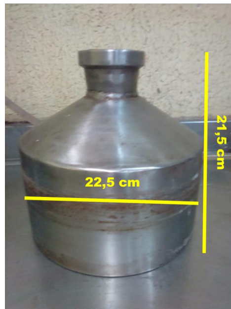
Figura 19 – Visão geral de uma tampa da dorna de aço inox com selo d'água demonstrando suas dimensões externas.
