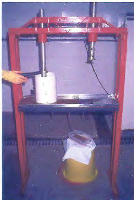
**FIGURA 5** - Prensagem da matéria-prima após cocção.
