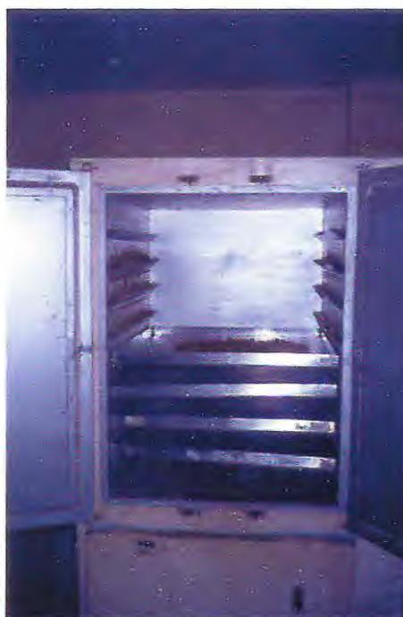
**FIGURA 7** - Secagem em estufa da torta de prensa.
