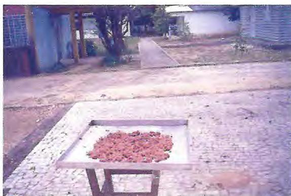
**FIGURA 6** - Secagem ao sol da torta de prensa.
