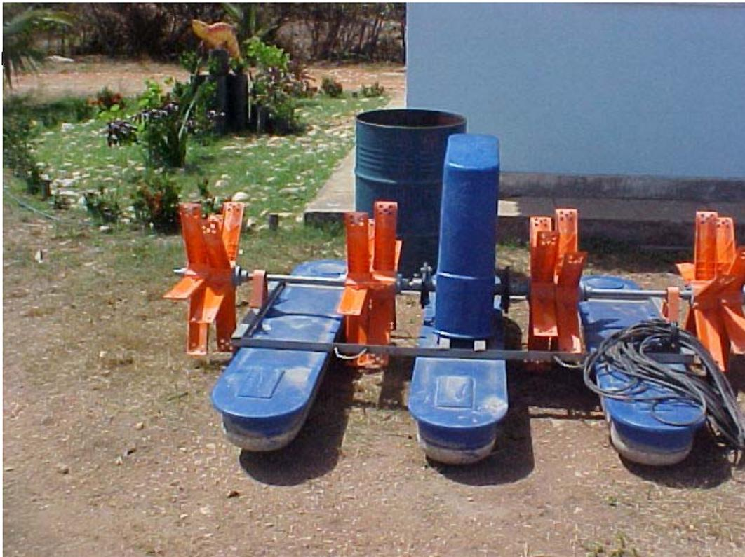
**Figura 3.16 - Modelos de aeradores utilizados nas fazendas**
