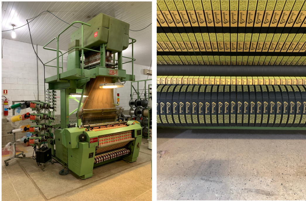
Figura 6 – A: Tear jacquard eletrônico de etiquetas; B: Rolos de etiquetas.
