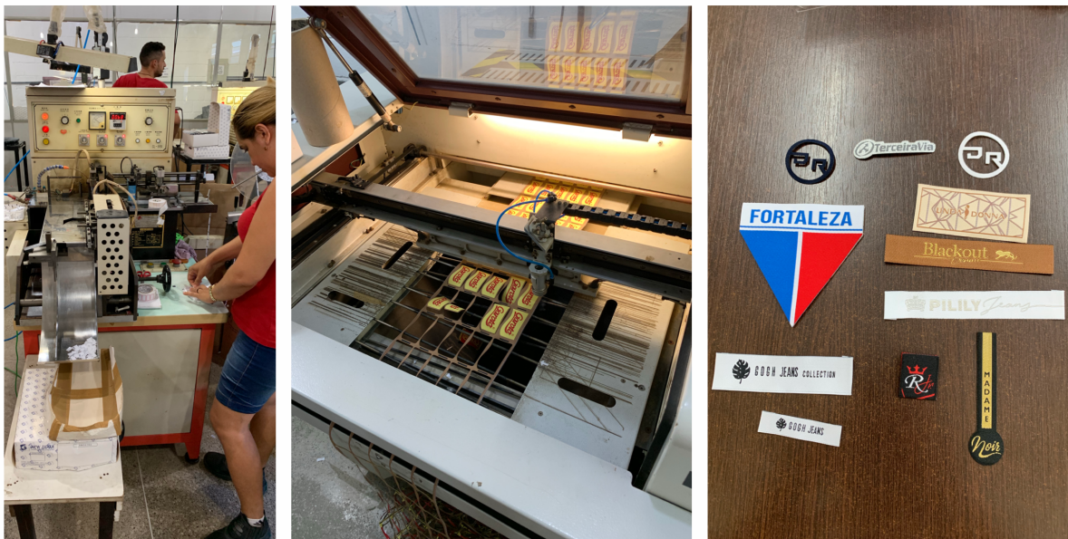
Figura 7 – A: Máquina de acabamento de etiquetas; B: Máquina de corte a laser; C: Exemplos de etiquetas com acabamentos diferentes.
