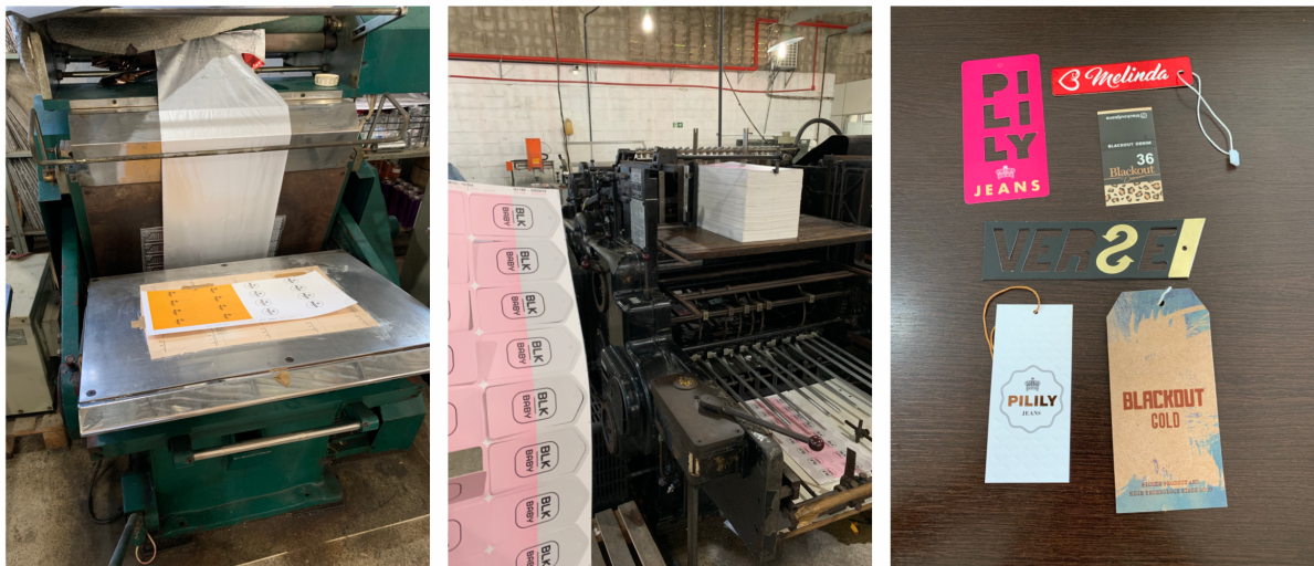
Figura 10 – A: Máquina de aplicação de hot stamping em papel; B: Máquina de corte; C: Exemplos de tags com acabamentos diferentes.
