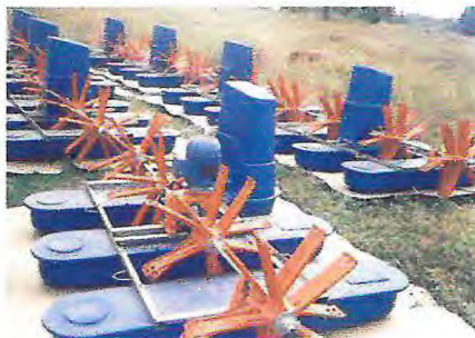
Figura 28 - Aeradores de pás de 2 HP.
