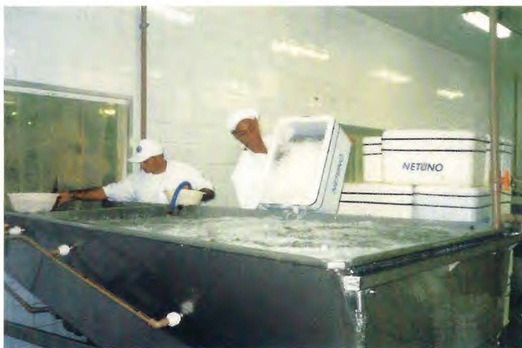
Figura 2. Tanque separador de gelo
