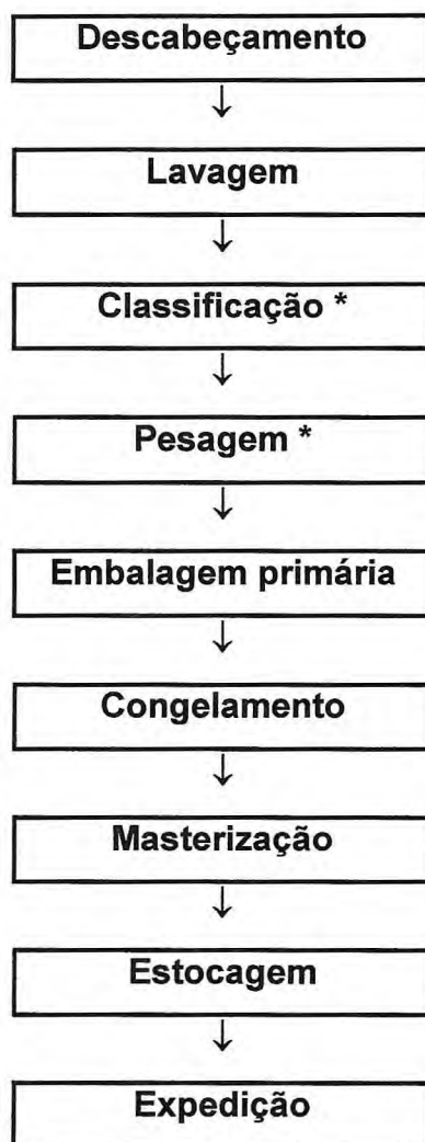
Figura 13. Fluxograma do processo de obtenção do camarão congelado sem cabeça (“head-less”).
