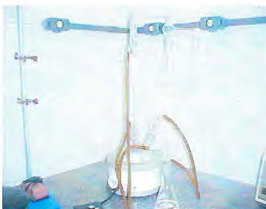
Figura 14. Equipamento utilizado para análise do residual de SO 2 pelo método Monier Williams.
