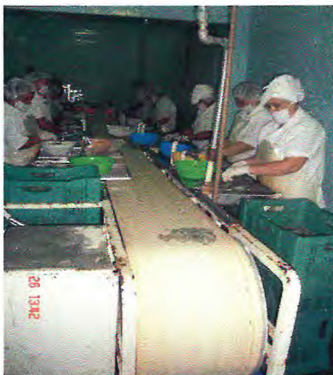
Figura 12 - Esteira de filetagem adaptada para "descabeçamento".
