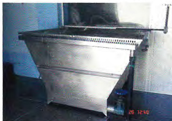
Figura 1.2 - Tanque separador de gelo (Perspectiva)
