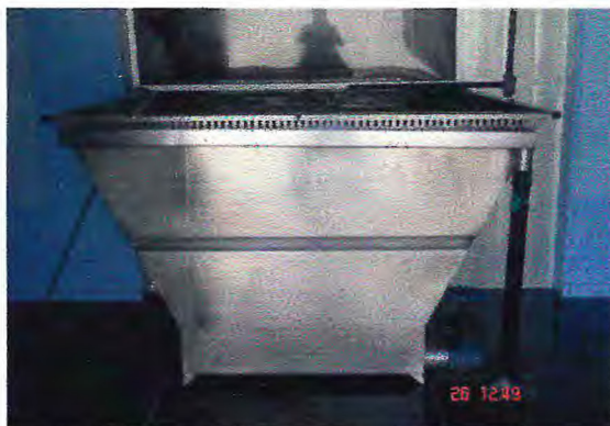
Figura 1.1 - Tanque separador de gelo (Vista frontal)
