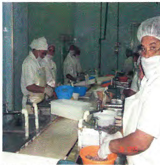
Figura 13 - Retirada do cefalotórax. ("descabeçamento")
