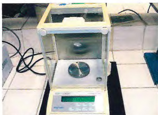
FIGURA 7 – Balança analítica utilizada para pesar as amostras desidratadas.
