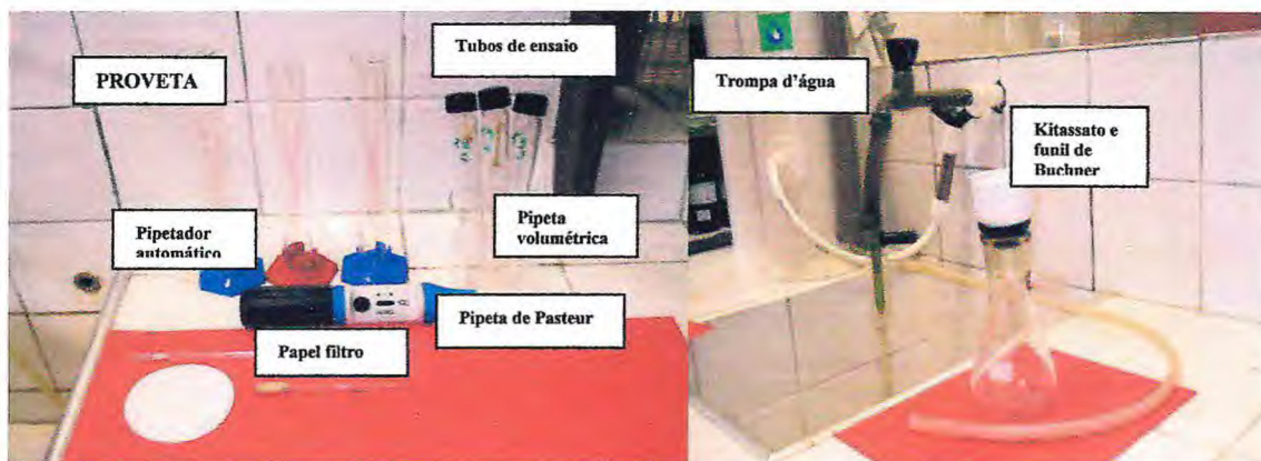
FIGURA 2 – Materiais usados na extração de lipídios pelo método & Dyer adaptado.
