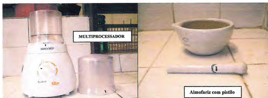
FIGURA 6 – Instrumentos utilizados para homogeneizar as amostras desidratadas.
