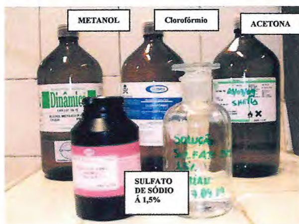
FIGURA 5 – Reagentes usados para extração de LT pelos métodos Soxhlet e Bligh & Dyer adaptado.
