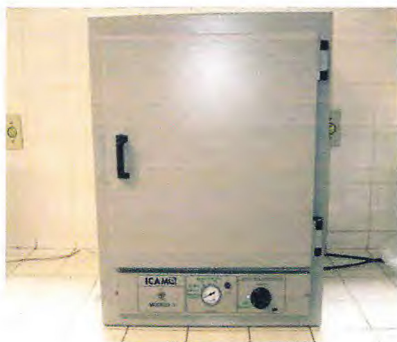
FIGURA 4 – Estufa utilizada para desidratar as amostras de tilápia e mapará.
