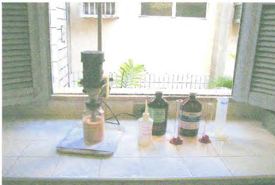
FIGURA 2 – Aparentagem para extração de lipídios totais pelo método de Bligh & Dyer (1959).
