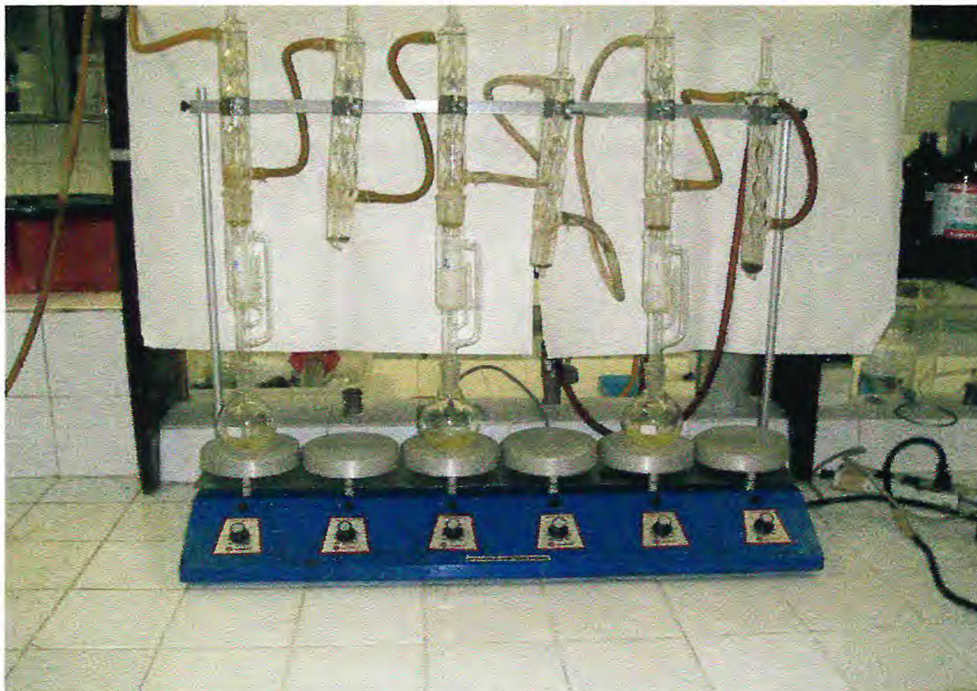
FIGURA 1 – Aparelhagem para extração de lipídios totais pelo método de Soxhlet.
