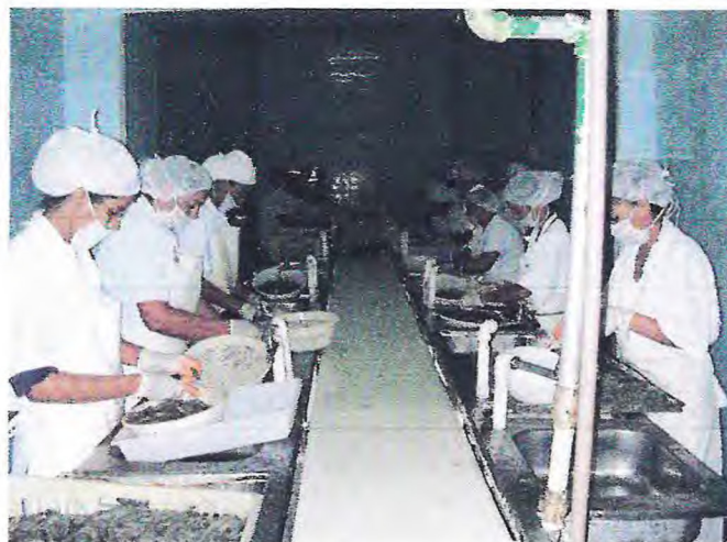
Figura 20. Descabeçamento manual do camarão
