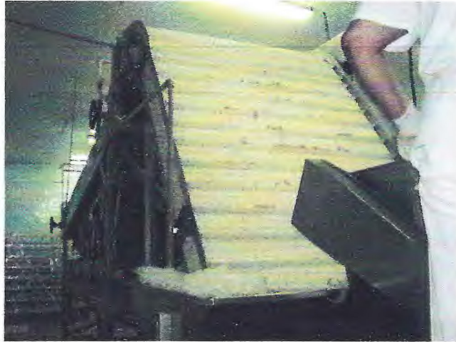
Figura 9. Esteira elevatória para transporte dos camarões
