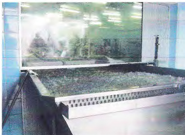
Figura 6. Tanque separador de gelo
