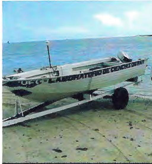
**Figura 6** – Embarcação com sistema de localização GPS e ecobatímetro utilizada em campo.
