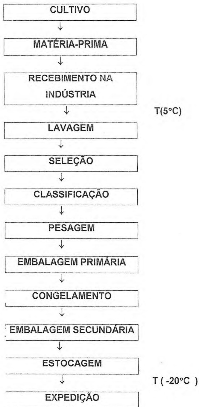
Figura 4 – Fluxograma do processamento do Camarão Inteiro Congelado, na Indústria de Frio e Pesca S.A – IPESCA.
