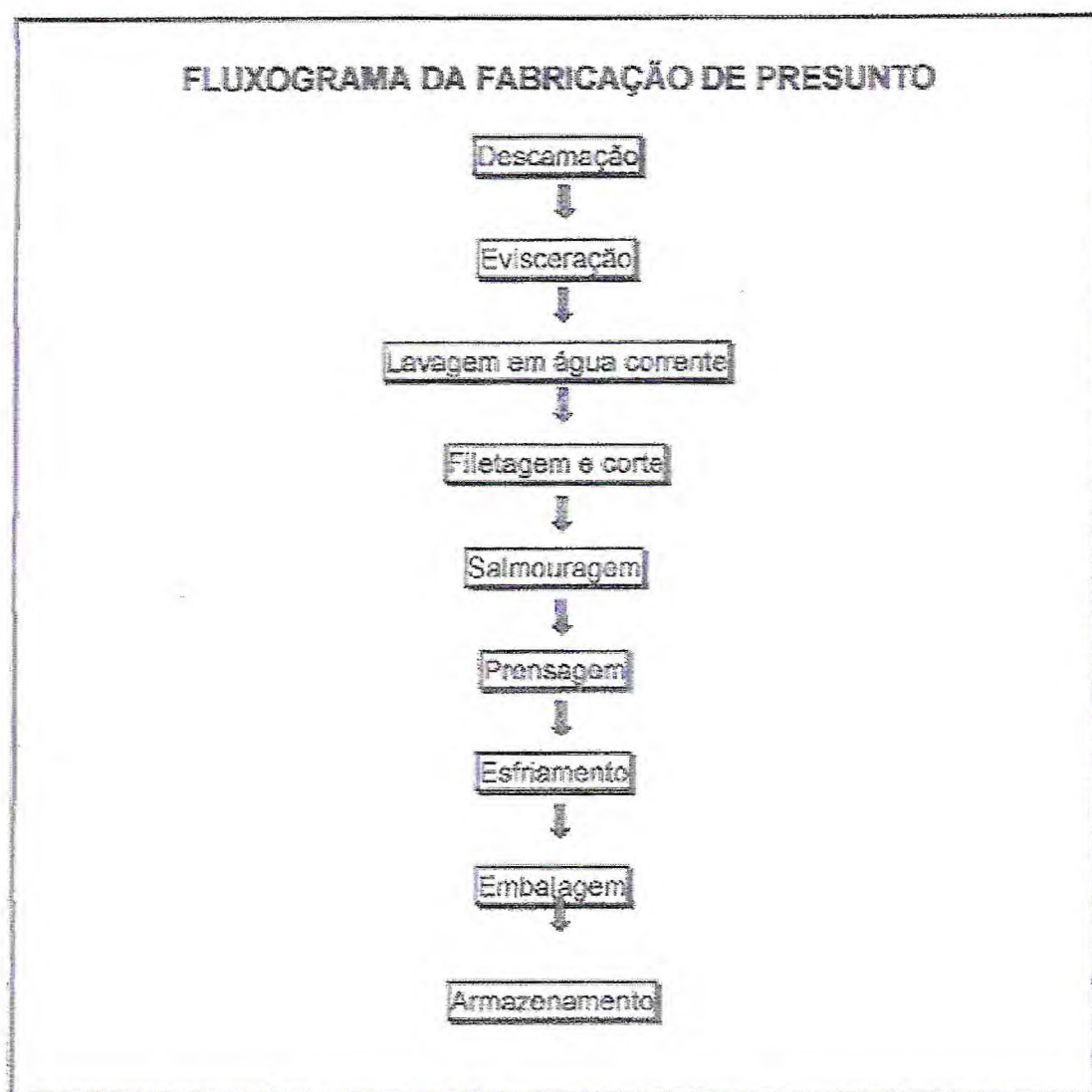
Figura 16 – Fluxograma da fabricação de presunto de tilápia.
