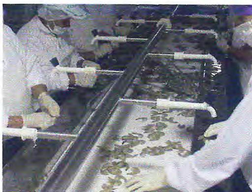
Figura 32. Camarão sendo descabeçado na esteira de dupla canaleta
