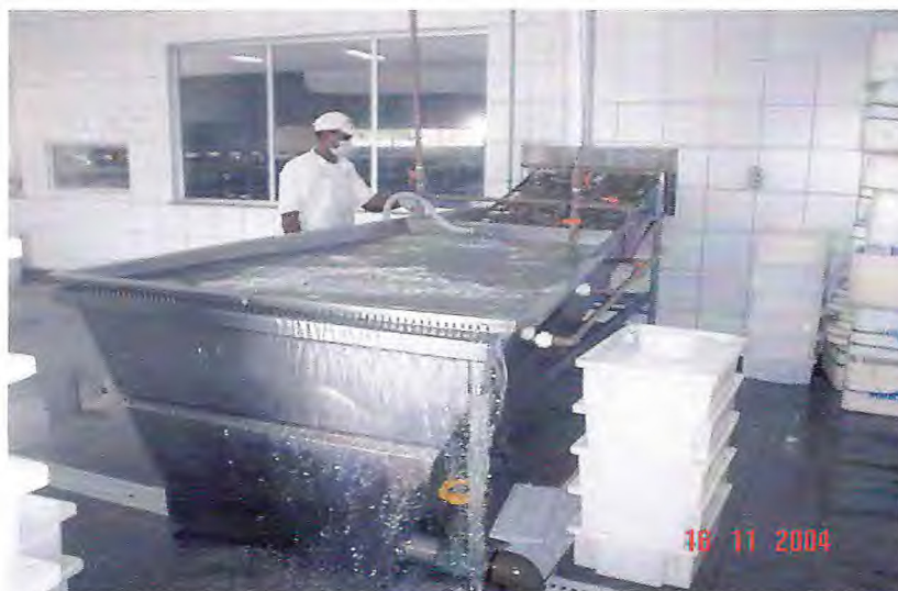
FIGURA 03 - Tanque Separador de gelo
