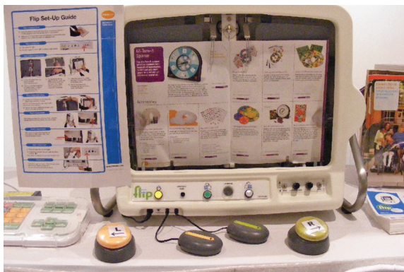
Foto 22 - Virador de página automático onde o livro é fixado e a ação de virar a página é ativada por acionadores (pressão, sopro, ou qualquer outra habilidade do aluno).
