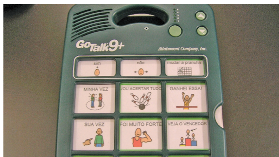
Foto 56 - Vocalizador de voz gravada com capacidade de 5 pranchas de comunicação pré programadas. O vocalizador tem 12 teclas com símbolos; quando a tecla é pressionada, ouve-se uma voz falando a mensagem correspondente ao símbolo.
