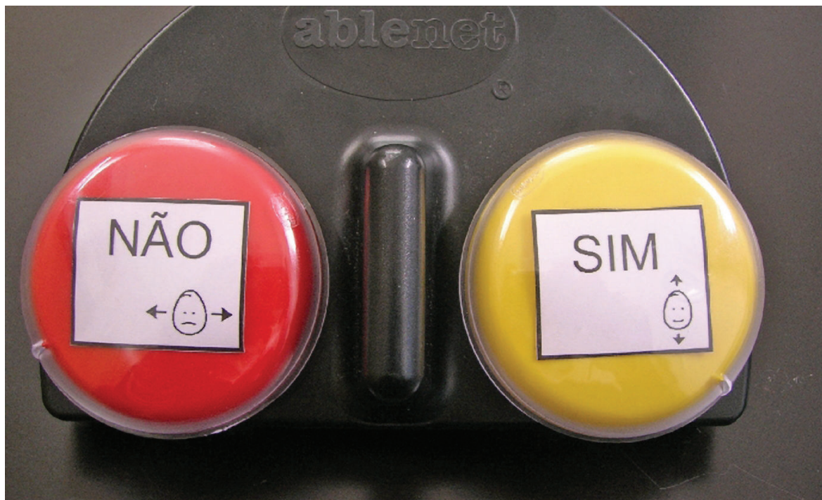
Foto 60 - Vocalizador de duas mensagens gravadas que são facilmente modificadas. Um tampo de plástico transparente em cada um dos botões abriga o símbolo gráfico que representa a mensagem gravada. Nesse caso, o vocalizador está preparado para as mensagens SIM (botão amarelo) e NÃO (botão vermelho).
