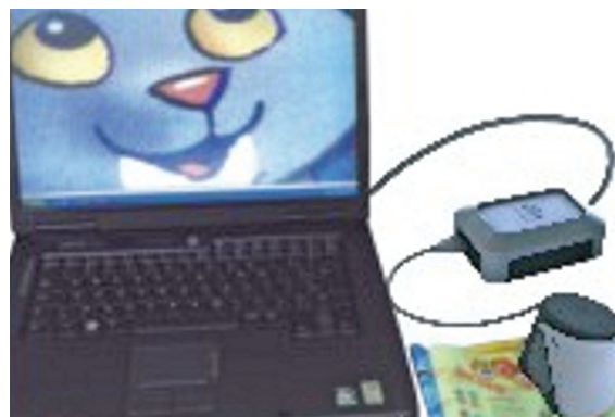
Foto 27 - Sistema de ampliação de texto onde uma câmera é manuseada pelo aluno, que passa o equipamento sobre o texto ou gravura e este é ampliado na tela de um computador ou monitor de TV.
