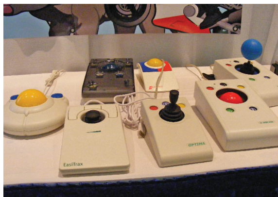
Foto 13 - Mouses especiais. Sete mouses de diferentes formatos, onde o direcionamento do cursor é feito com joystick ou manuseando-se uma grande bola colocada sobre o mouse. Os botões de ativação do clique e da tecla direita são dispostos no próprio mouse.
