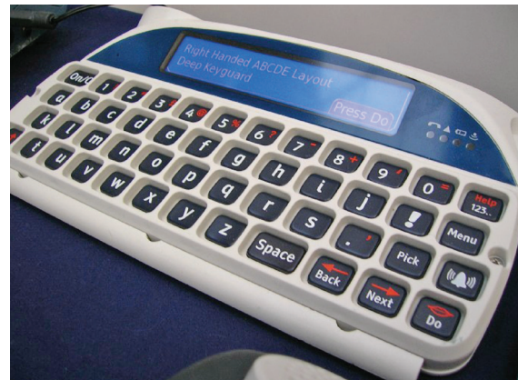
Foto 59 - Vocalizador portátil, que possui um teclado e um pequeno visor, onde a mensagem digitada é lida, ao mesmo tempo em que é falada.
