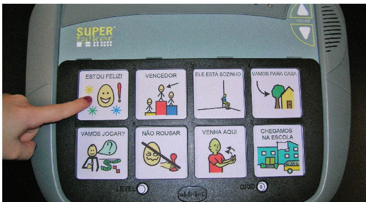
Foto 84 - Vocalizador com oito áreas de mensagens gravadas. Cada botão contem uma fala, que é ativada pelo aluno durante o desenrolar da peça de teatro.
