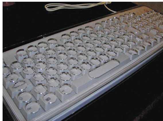
Foto 10 - Teclado coberto por uma colméia de acrílico transparente. A colméia é uma placa com furação coincidente às teclas e utilizada por alunos com problemas de coordenação motora. Esse recurso tem o objetivo de eliminar ou diminuir os erros de digitação.
