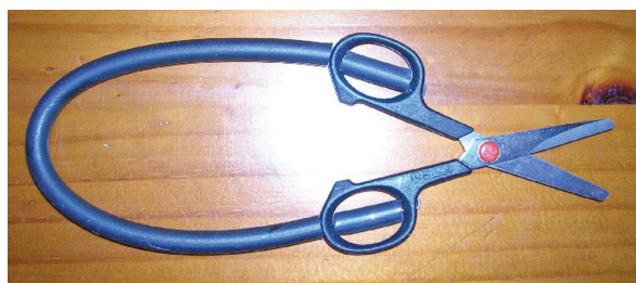
Foto 85 - Tesoura comum que é modificada através da colocação de um arame revestido de borracha no local onde são colocados os dedos, fazendo com que ela permaneça aberta, e facilite o movimento de recorte para alunos com problemas motores nas mãos.
