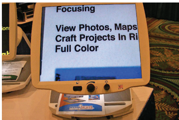
Foto 26 - Ampliador de texto onde o livro é colocado em uma superfície. O texto, ou imagem, é captado por câmeras para visualização ampliada no monitor.
