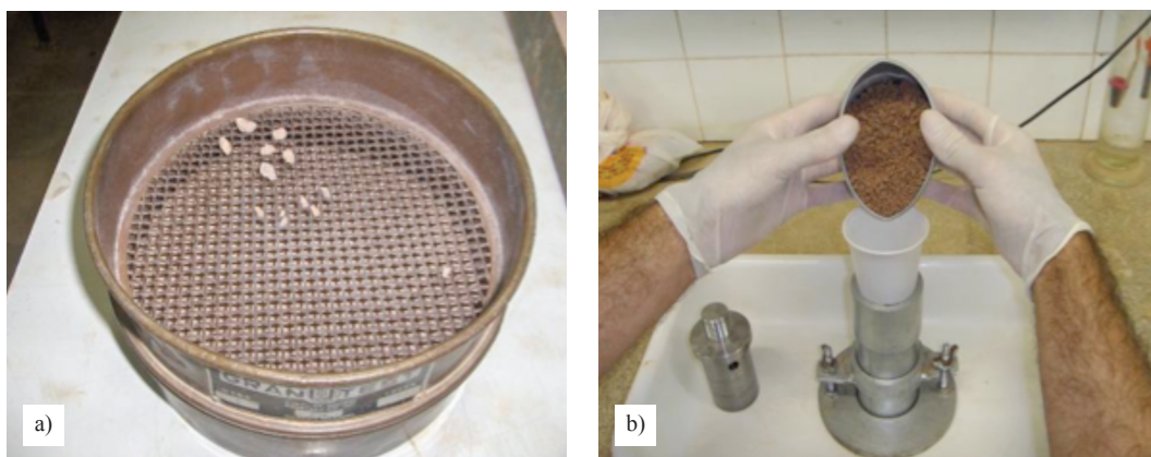
Fig. 3 – a) Grãos retidos na peneira n.º 4 (4,8 mm); b) Moldagem de corpo de prova com h = 10 cm e \phi = 5,0 cm (Guedes, 2013).
