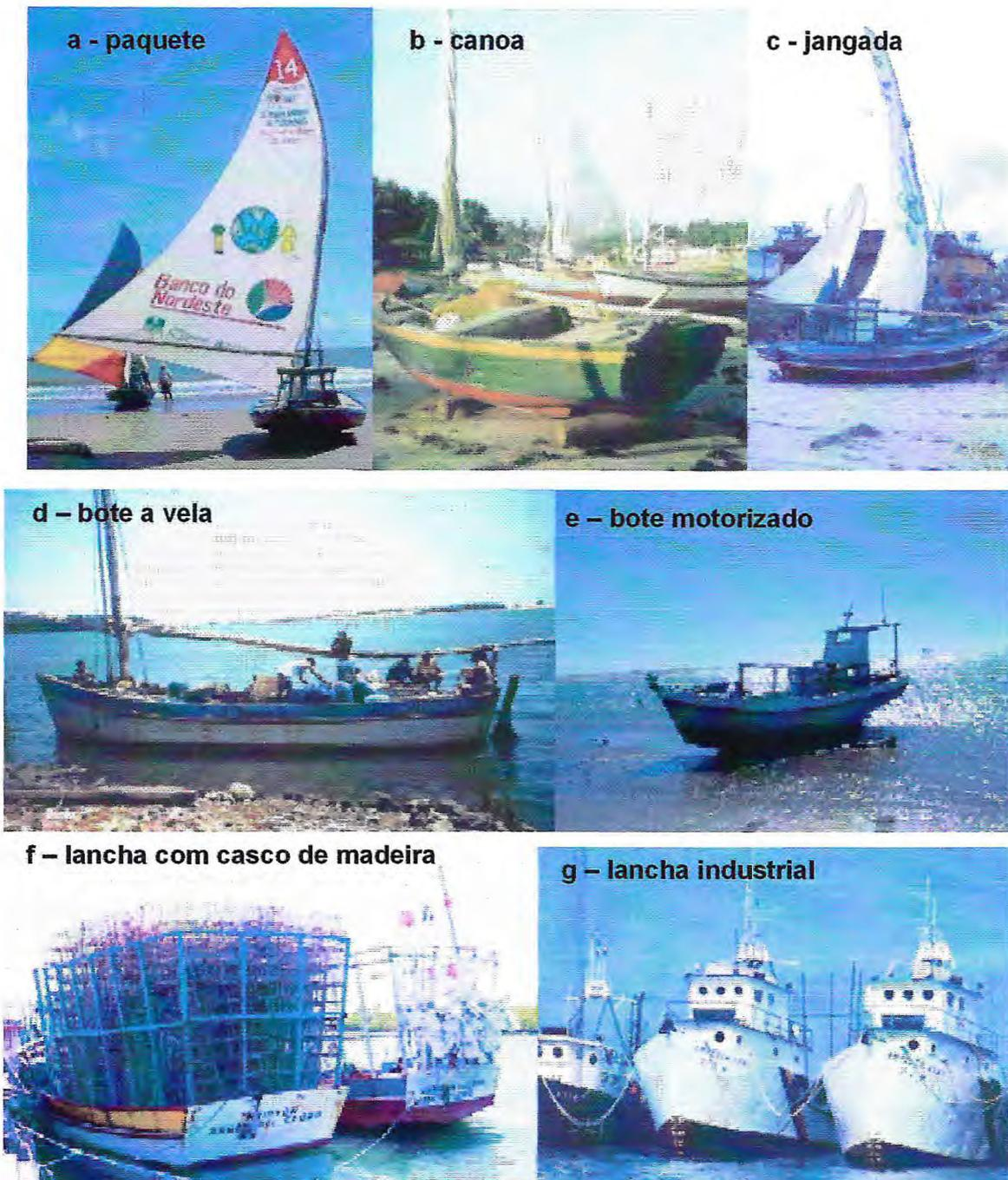
Figura 1 – Embarcações utilizadas nas capturas de lagostas, no Estado do Ceará.
