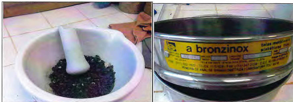
Figura 2.2 - Materiais utilizados para preparação das amostras almofariz de porcelana e depois é feito o Peneiramento dos sedimentos.
