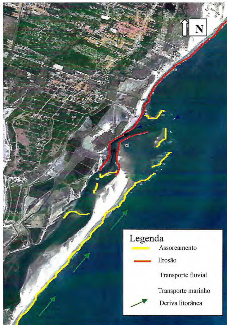
Figura 7.8 – Imagem de satélite (2010), mostrando a desembocadura do rio Pirangi a evolução da barra arenosa e área de sedimentação e erosão.
