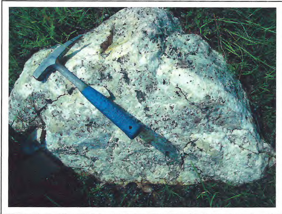
Foto 3.12 - Bloco rolado de brecha quartzítica com cristais de quartzo recristalizados. UR 32; Coord.: 329598/9636156.
