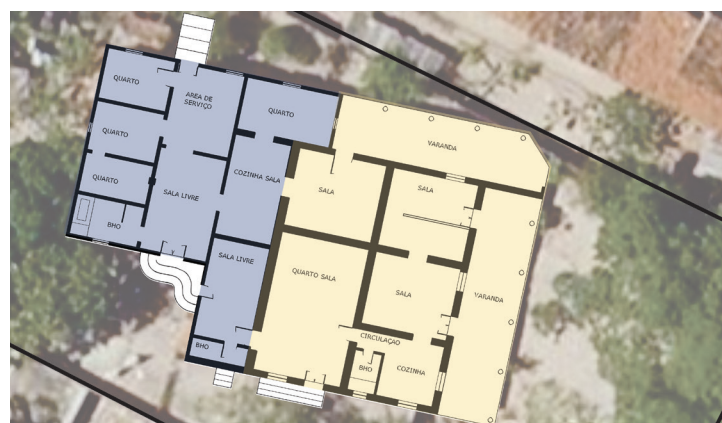
Figura 23: Planta atual mostrando compartimentos originais (em amarelo) e os acrescentados (em azul). Fonte: Elaborado pela autora.
